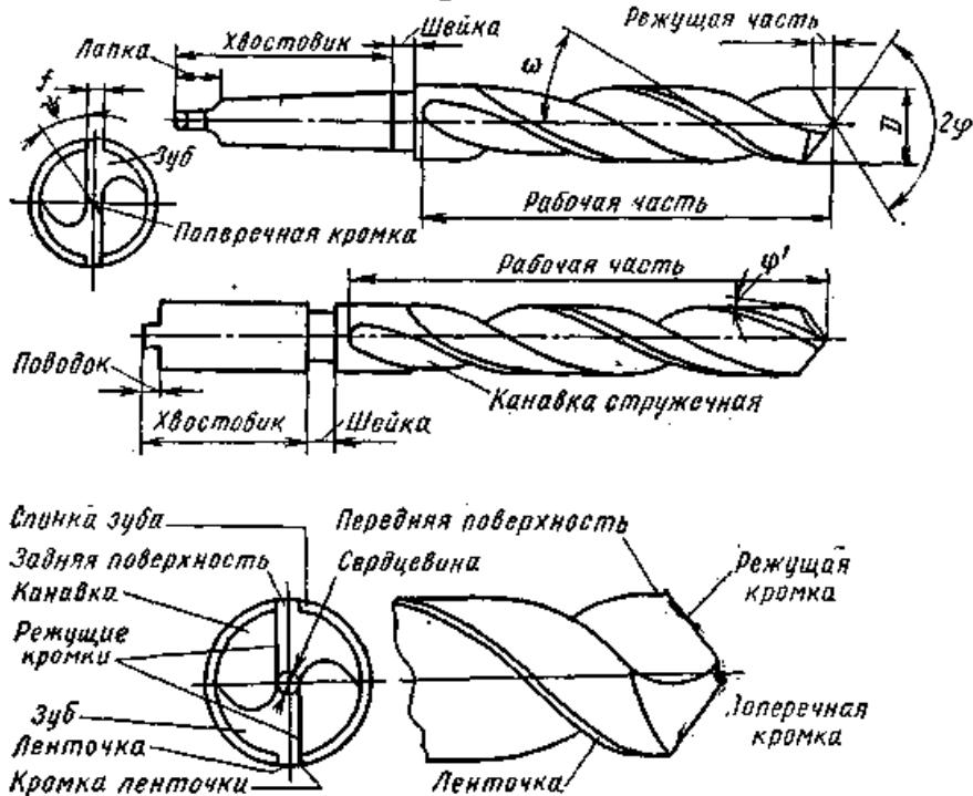
Рисунок 12.1 – Части и элементы спирального сверла
