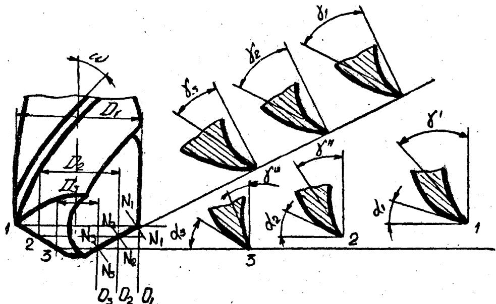
Рисунок 12.3 – Передние и задние углы спирального сверла
