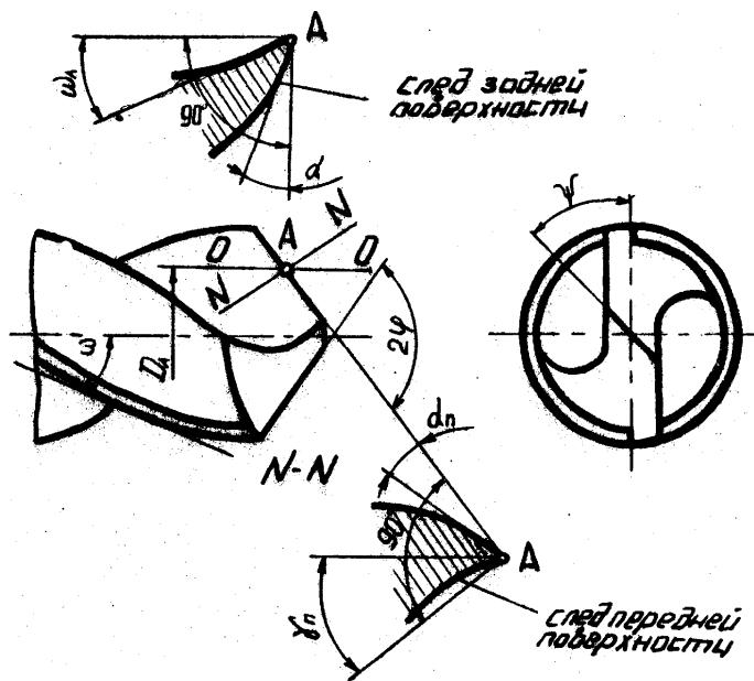
Рисунок 12.4 – Углы режущей части спирального сверла
