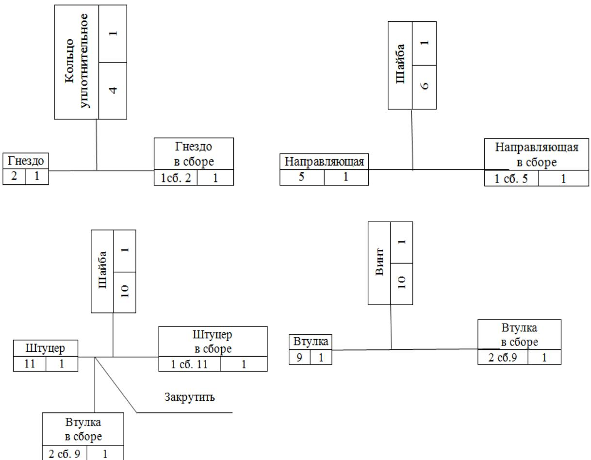
Рисунок 8.5 – Технологические схемы сборки узлов 1-го и 2-го порядков
