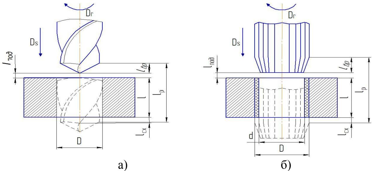
Рисунок 6.1 - Схемы для расчета длины обработки:
