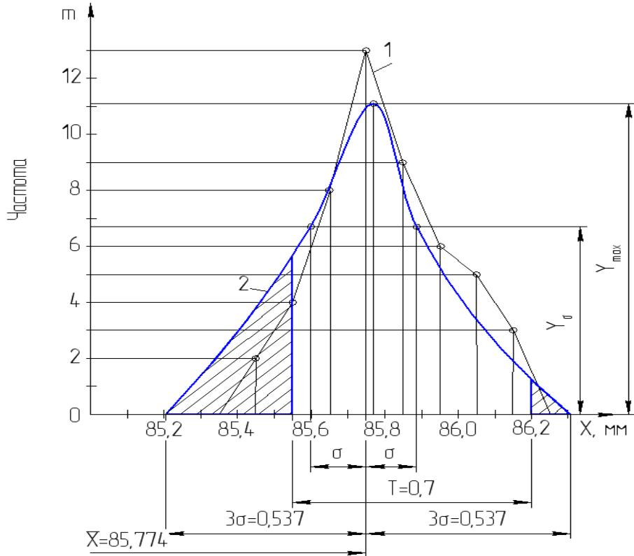
Рисунок 7.4 – Закон нормального распределения размеров: 1 – эмпирическая кривая распределения размеров; 2 – теоретическая кривая распределения размеров
