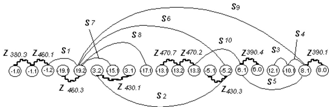
Рисунок 15.3 – Граф линейных конструкторских размеров и припусков
