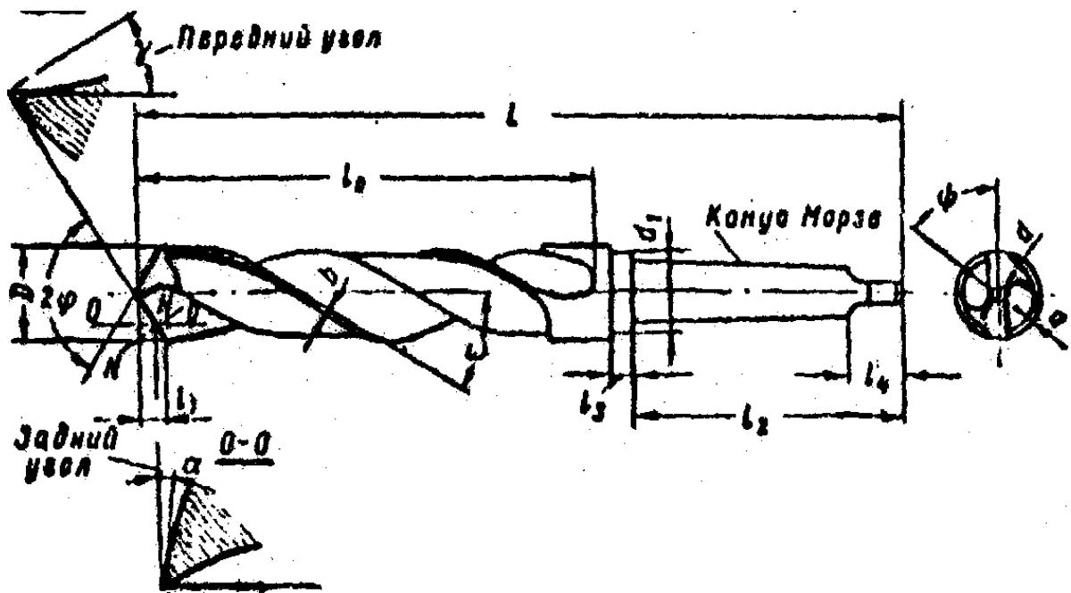
Рисунок 12.5 – Пример выполнения рабочего чертежа сверла.
