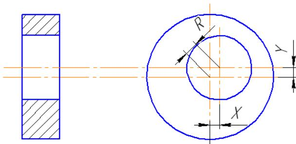
Рисунок 7.6 – Пример эксцентрикитета поверхностей
