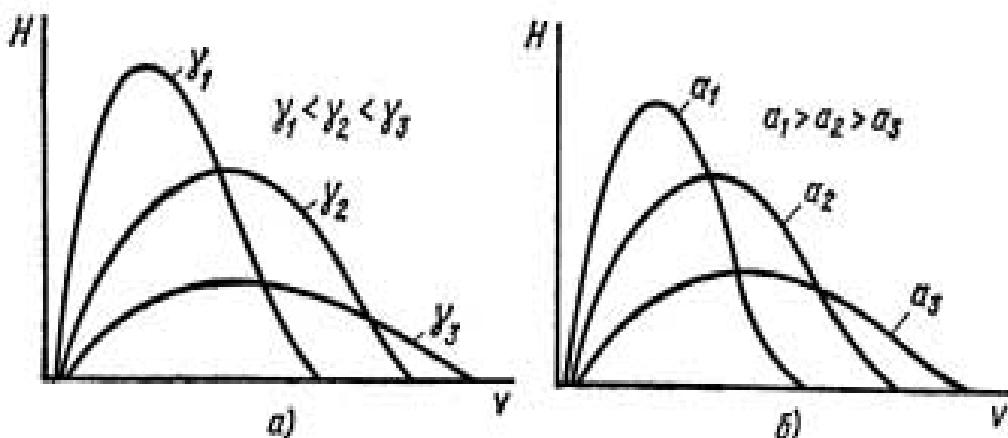
Рис. 3. Схема влияния скорости резания на высоту нароста при различных передних углах  $\gamma$  и толщинах  $a$  срезаемого слоя
