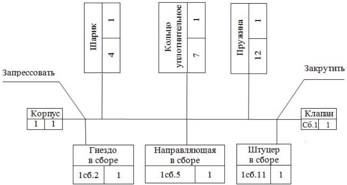
Рисунок 8.4 – Технологическая схема сборки изделия «Клапан»
