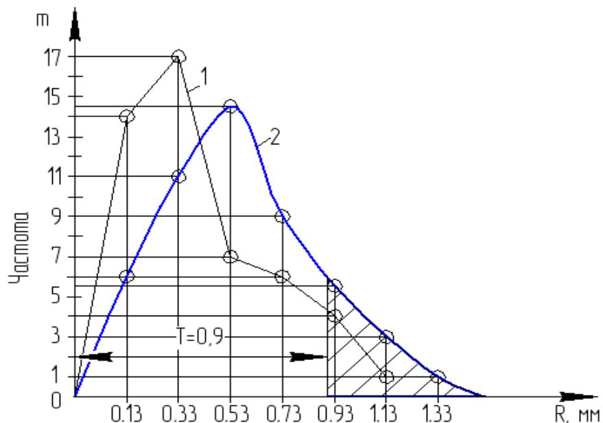
Рисунок 7.5 – Закон эксцентрикитета: 1 – эмпирическая кривая распределения; 2 – теоретическая кривая распределения
