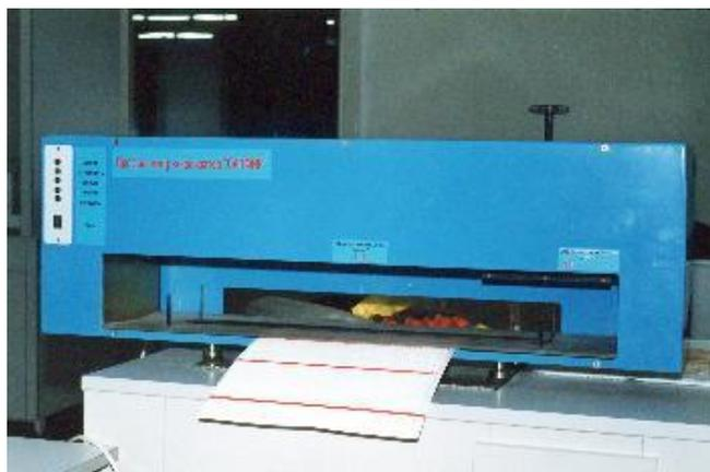
*Рис. 3.* Профилометр–анализатор
