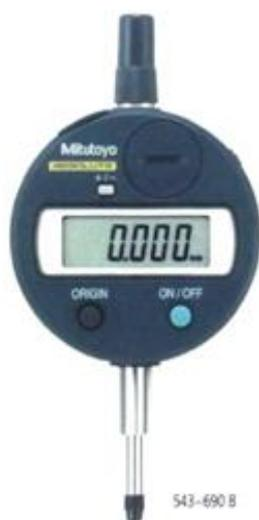
*Рис. 23.* Индикаторная головка
