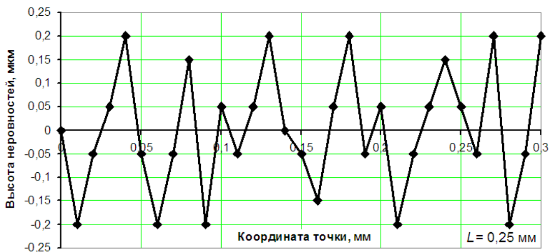
Рис. 6.1. Профилограмма поверхности детали
