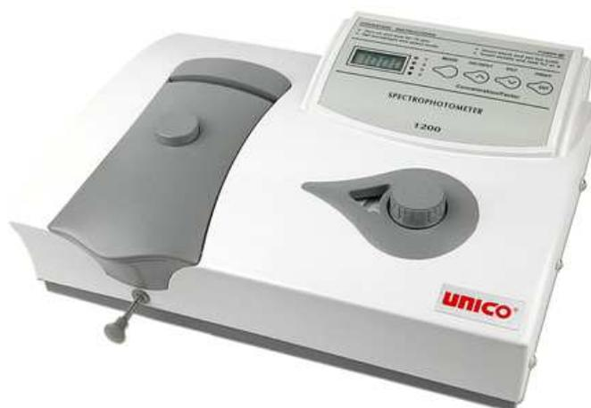
*Рис. 4.* Спектрофотометр UNICO 1200
