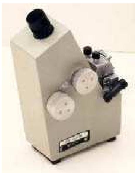
*Рис. 5.* Рефрактометр универсальный лабораторный
