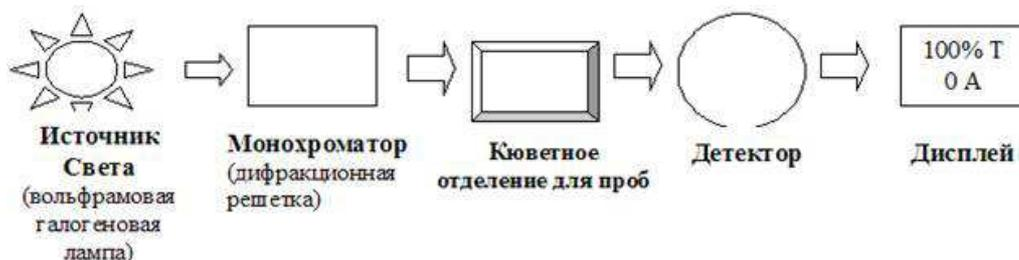
**Рис. 2.** Блок-схема спектрофотометра UNICO 1201/1200
